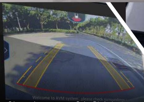
Cámara de reversa con Guías Dinámicas
