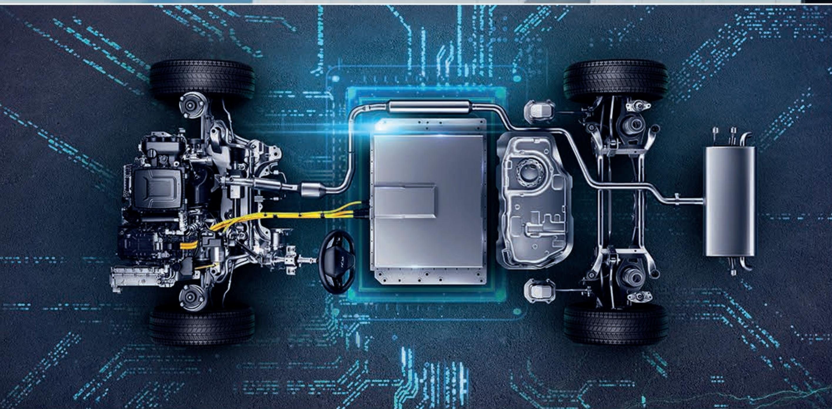
**BATERÍA DE 19.27 kWh**
