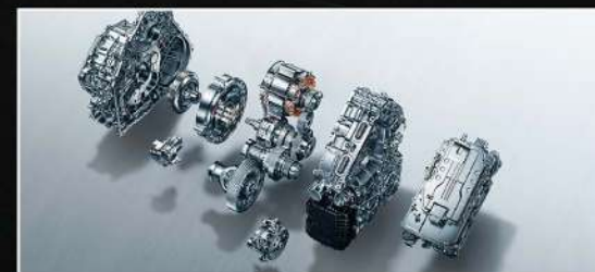
Tren Motriz con 2 Motores Eléctricos (55W y 70W)
